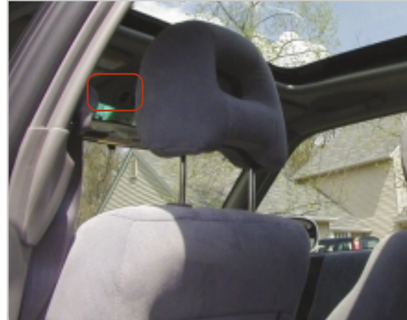
TEST ARACI: Işık darbeleri gönderen ve yansımalarını yakalayan PMD otomobilin tavanında yer alıyor.
