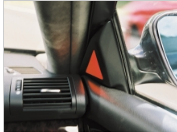
UYARI ÜÇGENİ: Kırmızı ışık tehlike olduğunu bildiriyor, sensör, kör noktada başka bir aracı tespit etmiş durumda.
