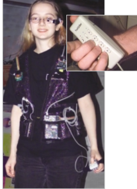
15 TUŞ KLAVYE: 15 tuşlu bir joystick, cep telefonu tuş takımları gibi, aynı zamanda bilgisayarın klavyesi olacak.
