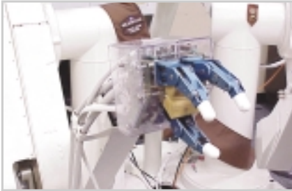
HASSAS ELLER: Robonot için geliştirilen eller vida sıkabilecek, tıpkı insan eli gibi, hassas işler yapabilecek.
