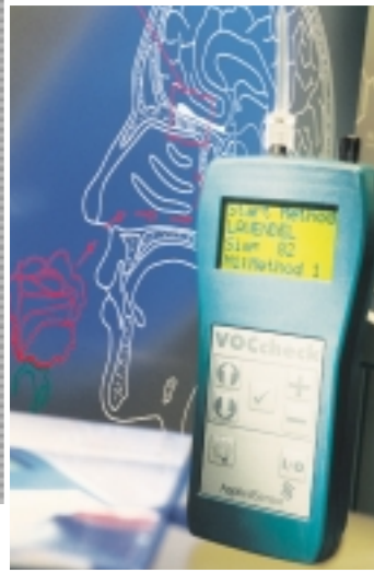
KOKLAMAK: Yapay burnun kokuları tanıması için, 4 adet koku sensörü yetiyor.
